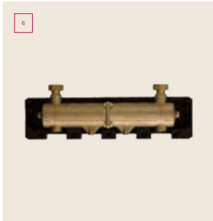
Hydraulický separátor Toto příslušenství hydraulicky odděluje stranu okruh tepelného čerpadla a okruh koncových topných prvků. ATW-HSK-01
