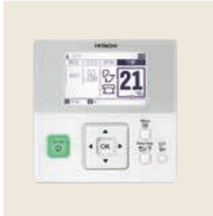
Kabelový ovladač pro Hydrofree PC-ARFWE Ovladač s optimalizovaným softwarem pro řízení hydromodulu LCD obrazovka Funkce ECO Výběr křivky teploty vody (ekvitermní křivka, body, fixní) Omezení min/max nastavitelných teplot Řízení ohřevu TUV Řízení přídavného elektroohřevu Řízení oběhového čerpadla Funkce Smart Grid Rozměry (v × š × h): 120 × 120 × 20 mm Kompatibilita: volitelné pro RWLT-NV1E nutné pro RHWT-5.0VNF1E
