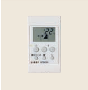
Jednoduchý kabelový ovladač PC-ARH1E Možnost současného řízení až 16 vnitřních jednotek. Ovládané základní funkce: - zapnutí/vypnutí - nastavení teploty po 0,5 °C - provozní režim (chlazení/vytápění/auto/odvlhčování/cirkulace) - rychlost ventilátoru - natočení lamel 80 volitelných funkcí včetně: - automatický režim chlazení/vytápění s nastavením dvojí teploty - výběr čidla teploty - funkce útlumu provozu (setback) řízená externím signálem (např. hotelová karta) - zámek vybraných funkcí - omezení nastavitelných teplot - autorestart - přístup k servisním funkcím na výběr vstupních/výstupních signálů Zabudované čidlo teploty Rozměry (v × š × h): 120 × 70 × 15 mm
