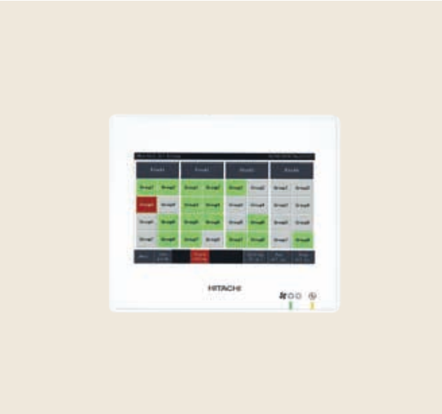
Centrální řízení s dotykovou obrazovkou PSC-A32MN 5" barevná dotyková obrazovka Řízení a správa až 32 skupin vnitřních jednotek Na jeden H-link může být napojeno až 8 těchto zařízení Hlavní funkce: - zapnutí/vypnutí - nastavení teploty - provozní režim (chlazení/vytápění/auto/odvlhčování/cirkulace) - rychlost ventilátoru - natočení lamel - výběr zamknutých funkcí na lokálních ovladačích - až 5 provozních úseků denního rozvrhu - nastavení prázdninového rozvrhu - záznam posledních 100 alarmů Volitelné funkce: - omezení nastavitelných teplot - zobrazení provozních hodin - rozvrh výkonu venkovní jednotky (100-40%) - přístup k servisním funkcím na výběr vstupních/výstupních signálů (např. pro ON/OFF všech systémů, nouzové zastavení, monitoring alarmu) Napájení 230 V Rozměry (v × š × h): 140 × 120 × 22 (53) mm Kompatibilita: všechny VRF vnitřní jednotky
