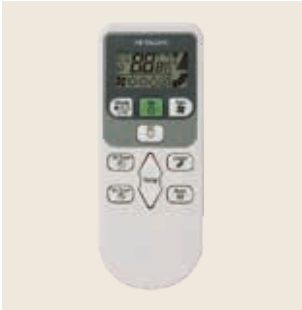
Infra ovladač PC-AWR Možnost řízení až 16 vnitřních jednotek jedním ovladačem, pokud jsou připojeny k jednomu infra přijímači. Možnost uchycení na stěnu pomocí plastového držáku dodávaného s ovladačem. Ovládané funkce: - zapnutí/vypnutí - nastavení teploty - provozní režim (chlazení/vytápění/auto/odvlhčování/cirkulace) - rychlost ventilátoru - natočení lamel - denní rozvrh Rozměry (v × š × h): 140 × 55 × 17 mm
