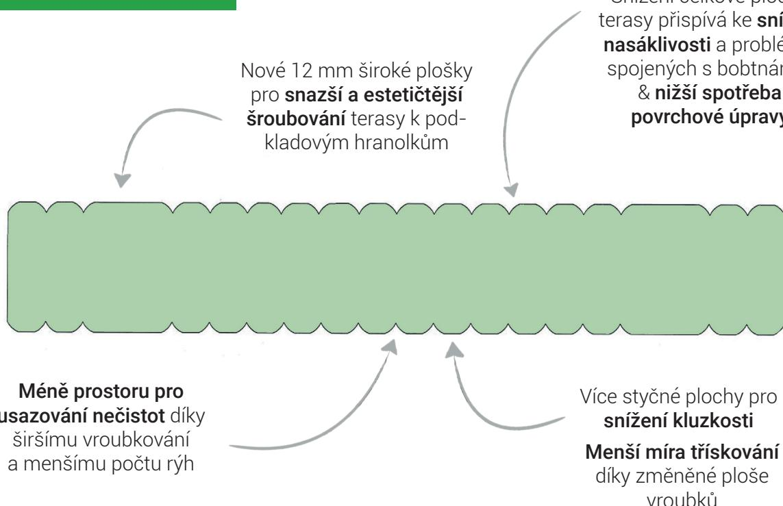
SECA vždy doporučuje zvážit možnost použití hladké terasy. Četné výzkumy dokázaly, že vroubků nepřispívají ke snížení kluzkosti a naopak mohou dle Holzforschung Austria vést k většímu zanášení terasy nečistotami a četnějším špičatým třískám.
