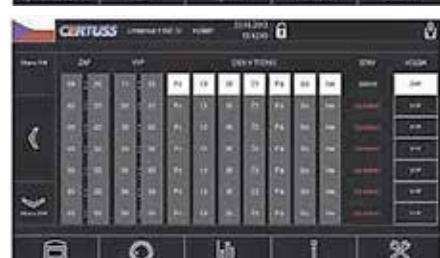
Ukázka zobrazení pro volbu dní pro právě nastavený režim provozu s nastaveným zapínacím a vypínacím časem provozu parního vyvíječe.
