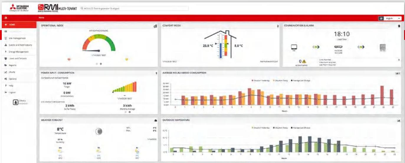
KPI (Key Performance Indicator) poskytuje rychlý přehled o všech důležitých parametrech zařízení, jako je například aktuální spotřeba energie nebo efektivita provozu. Pro každou lokalitu existuje libovolné množství přístupů, proto můžete zřídit servisní přístup i pro servisní organizaci podle svého výběru.
