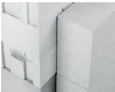
Plynosilikát 450 mm > nahrazuje 120 mm tepelné izolace
