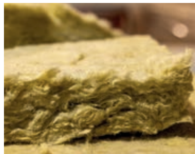
100 mm minerální izolace stará 30 let a více > nahrazuje 80 mm tepelné izolace
