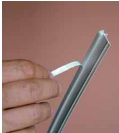
Prvním krokem při zaprvování okenní špalety je vyspravení větších nerovností zdiva, které se provede omítkou Rimano UNI nebo sádrovou omítkou, která je použita na ostatních plochách místnosti. Z APU lišty se odstraní lepicí páiska na mechovce, která bude tvořit dilataci mezi okenním rámem a omítkou.
