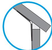
b) dilatačním PVC profilem
