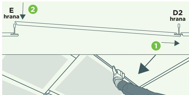
Kazetu nebo lamelu vkládáme vždy v místě, kde nám nepřekáží závěs. Kazety se vkládají podle schématu a postupuje se od středu místnosti. Lamely Xtensiv vkládáme standardně jako kazety s hranou A nebo E15. Kazety i lamely je možné po vložení posunout do finální polohy.
