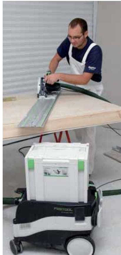
Konstrukční a speciální desky je doporučeno řezat okružní pilou s vodící lištou a odsáváním
