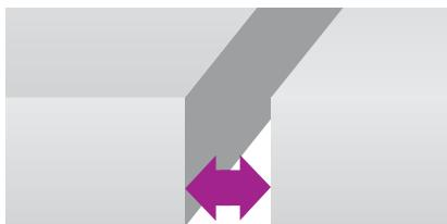
Při tmelení spár je nezbytně nutné, aby šířka spáry byla 5 mm (max. 10 mm)
