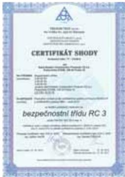
Konstrukce jsou certifikovány na bezpečnost proti protlačení a násilnému vniknutí a jsou ve shodě s požadavky kladenými na bezpečnostní třídu RC 2, RC 3 a RC 4 podle ČSN EN 1627.
