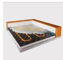
Podlahové vytápění/ chlazení 1.2.3 Mokrý systém
