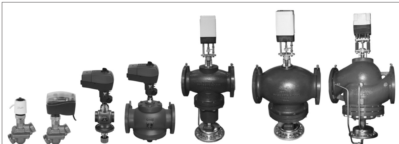
AB-QM ventil, vybavený servopohonem, představuje regulační ventil s plnou autoritou a funkcí automatického seřizování / omezení průtoku. Typická použití: Regulace teploty a automatické seřizování koncových jednotek (chladiče, vzduchotechnická zařízení, fan-coilové jednotky, indukční jednotky, vyzařovací panely a tepelné výměníky)
